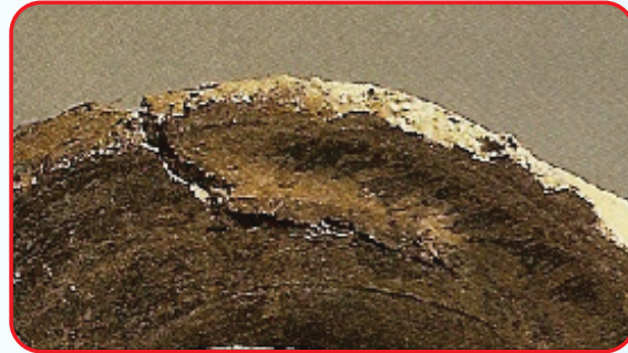
شكل (١٠٦): يوضح نتائج أخطاء التجفيف ( تشقق ).
