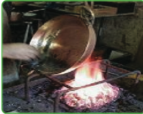
الشكل (٦٧): التخمير «تسخين المعدن لإكسابه اللدونة».
